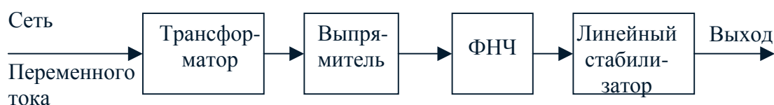
Рис. 1.3. Упрощенная функциональная схема линейного стабилизированного источника питания.
